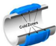
холодные зоны внутри фитинга и трубы
